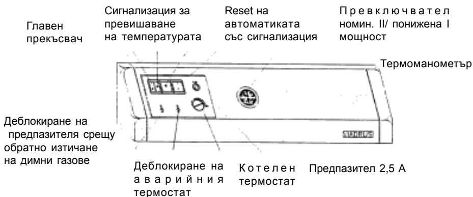
Фиг.25.а Стандартно управляващо табло на котел Viadrus G42 ECO с автоматика SIT
