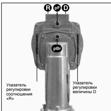
Регулятор SKP в комбинации с клапаном VGG/F поддерживает постоянное, регулируемое соотношение расхода газа и воздуха с устанавливаемым соотношением V, возможностью корректировки исходной величины N и подключением давления камеры сгорания.
