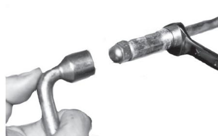
Открутите форсунку с помощью двух гаечных ключей 16 и 14 мм
