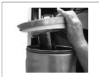
Изваждане нагоре на капака на горивната камера
