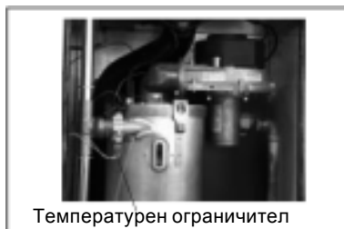
Развъртане в посока обратна на часовниковата стрелка на съда на горивната камера
